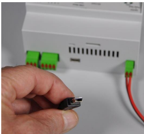
USB 2.0 Data cable Design: plug Type A to plug Mini Type B
