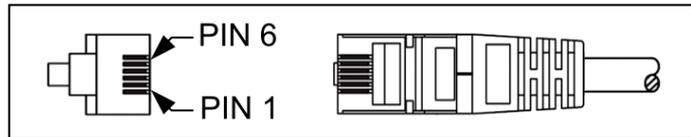
**Hinweis, der Sensor kann nicht direkt an den [1-Wire Adapter](#) oder [1-Wire Hub RJ45](#) angesteckt werden, da unterschiedliche Steckerbelegung!**
